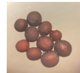
Abbildung 2: Links unten, mehrere Kapillarbrücken an einzelnen Senfkörnern, rechts Wassernester
